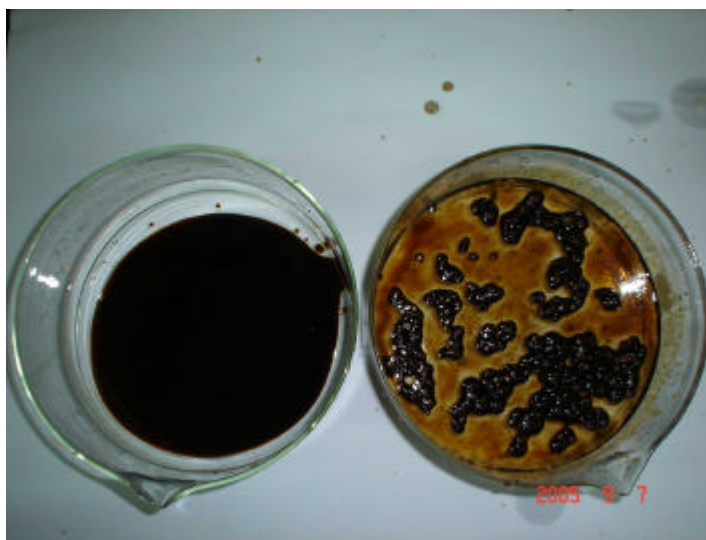
Figura 8. Izquierda: 15 \text{ cm}^3 de petróleo crudo desparramado sobre agua en una cápsula de Petri. Derecha: 15 \text{ cm}^3 de petróleo crudo mas 10 \text{ cm}^3 de emulsión cremosa sobre agua en una cápsula de Petri, sin agitación, situación inicial.
