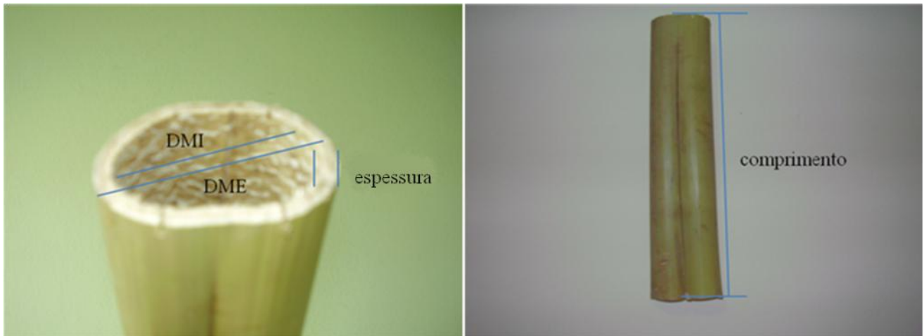
Figura 2. Amostra do colmo da espécie Bambusa vulgaris . Nota- DME: Diâmetro máximo externo. DMI: Diâmetro máximo interno.
