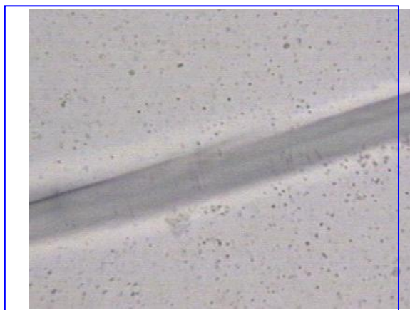
Figura 4. Microcápsulas de Triclosan comparadas contra una fibra acrílica 3 denier.
