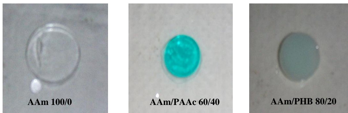
Figura 2. Imágenes de diferentes hidrogeles después de haber absorbido \text{Cu}^{2+} .
