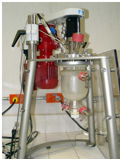
Figura 1. Reactor Buchi de laboratorio utilizado en la síntesis a nivel de laboratorio.
