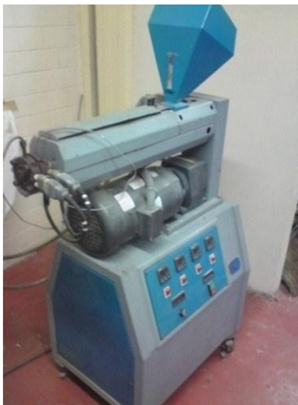
Figura 1. Extrusor monohusillo utilizado para la preparacion de las muestras.
