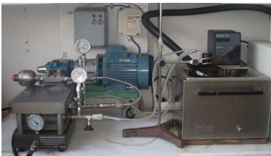
Figura 1. Fotografía del sistema de NF con las membranas NF 90 y MF 36.
