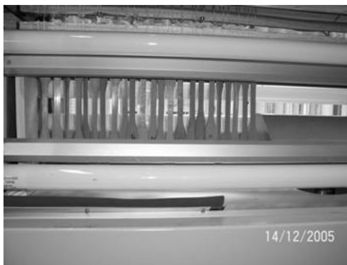
Figura 1. Disposição dos corpos de prova das amostras no interior da câmara de radiação UV para o ensaio de fotodegradação.
