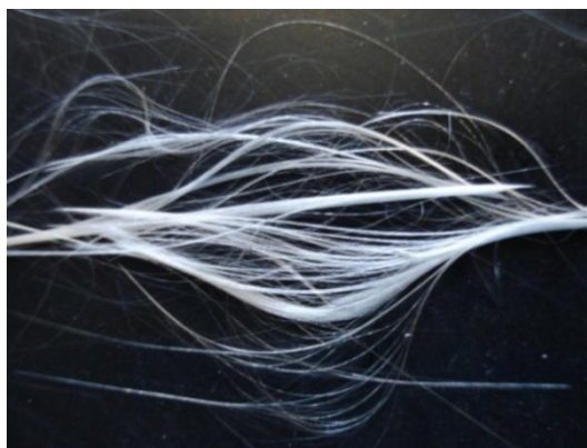
Figura 9. Fibras de vidro após imersão em etanol comercial.
