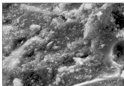
Figura 5. Micrografía del sistema catalítico \text{ZrCp}_2\text{Cl}_2\text{-MAO/AlPO}_4 (25 \mu\text{m} ).
