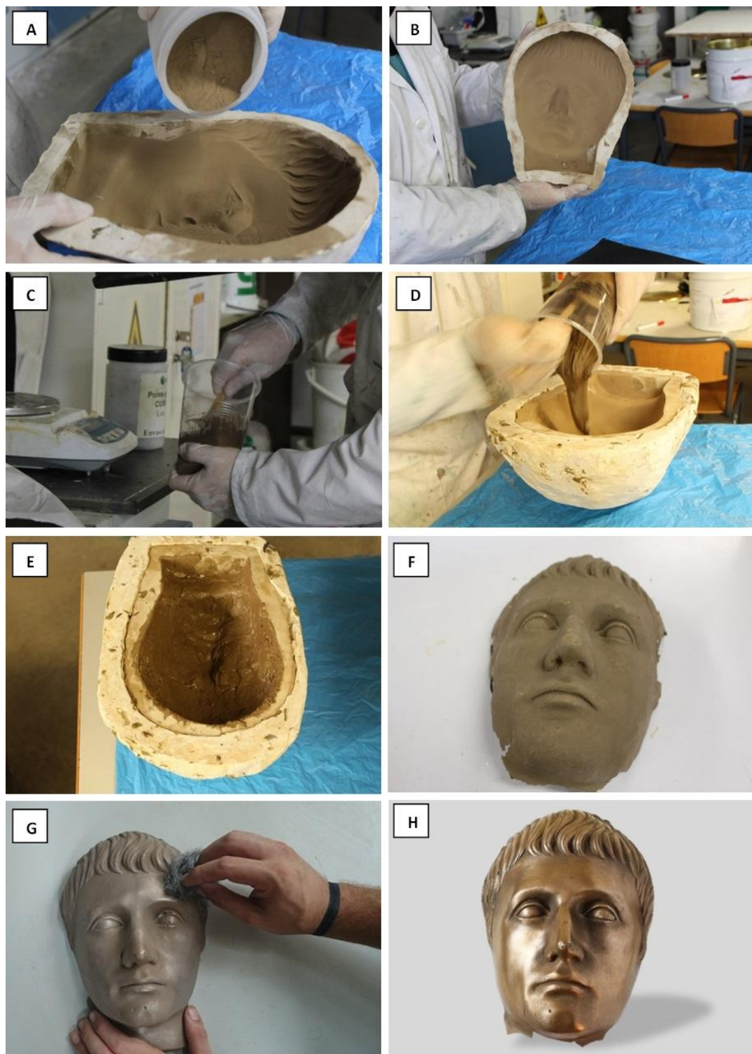
Figura 4. Proceso de obtención de una reproducción en metal artificial mediante estratificado. A) Vertido de polvo metálico en el interior del molde de silicona, B) Eliminación del depósito de polvo metálico sobrante, C) Preparación de la masilla de estratificado, D) Vertido en el interior del molde de silicona y distribución manual en el interior del mismo, hasta alcanzar un espesor homogéneo, E) tras el tiempo de curado indicado por el fabricante el material puede desmoldarse, F) Pieza desmoldada, de aspecto mate, G) Pulido de la superficie mediante lana de acero 0000, y H) Pieza tras ser pulida, con su característico aspecto metálico.
