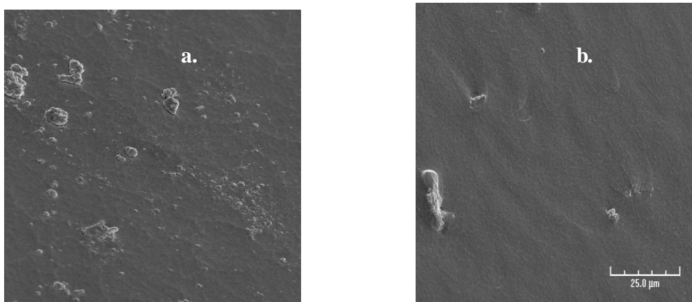
Figura 8 Microscopias SEM de los poliuretanos (a) del aceite de higuera sin modificar y (b) del Poliol 1. Relación NCH/OH = 1 (con potencial de aceleración: 15 kV, Aumento: *1200 (25 μm), distancia de trabajo (WD) = 15 mm
