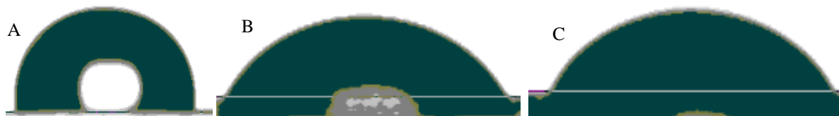
Figura 4. Imagen del ángulo de contacto en el papel. A) Papel estucado sin tratamiento, B) Papel estucado con 0,05 % CNxMWNTs y 13% SDS, y C) Papel estucado con 0,15 % CNxMWNTs y 13% SDS.
