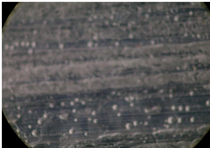
Figura 12. Microfibras resultantes obstaculizadas por la formación de mínimas gotas poliméricas, prueba 3-3.
