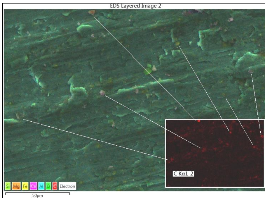
Figura 7. Mapa espectral da superfície da amostra analisada, indicando os elementos presente na superfície analisada (Fonte: central analítica UFC e acervo pessoal).
