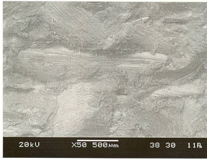
Figura 1. Componentes sin ningún tratamiento (fibra + polipropileno).
