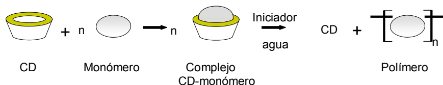
Figura 2. Mecanismo general de polimerización a partir del complejo ciclodextrina-monómero.
