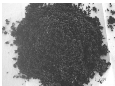
A (Mistura partículas de borracha com a resina PU)
