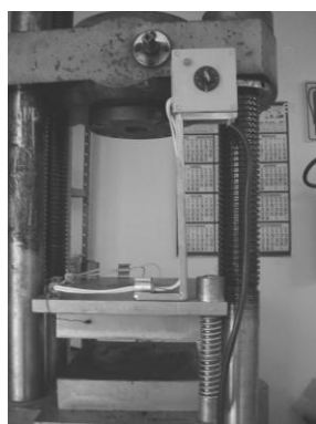
D (Dispositivo de aquecimento e prensagem do compósito)
