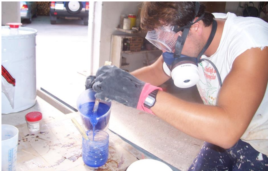
Figura 5. Utilización de gafas herméticas para evitar accidentales contactos de la resina con la mucosa ocular.
