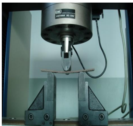
Figura 2. Teste de Flexão do corpo de prova após 180 dias de contato com a matéria orgânica.
