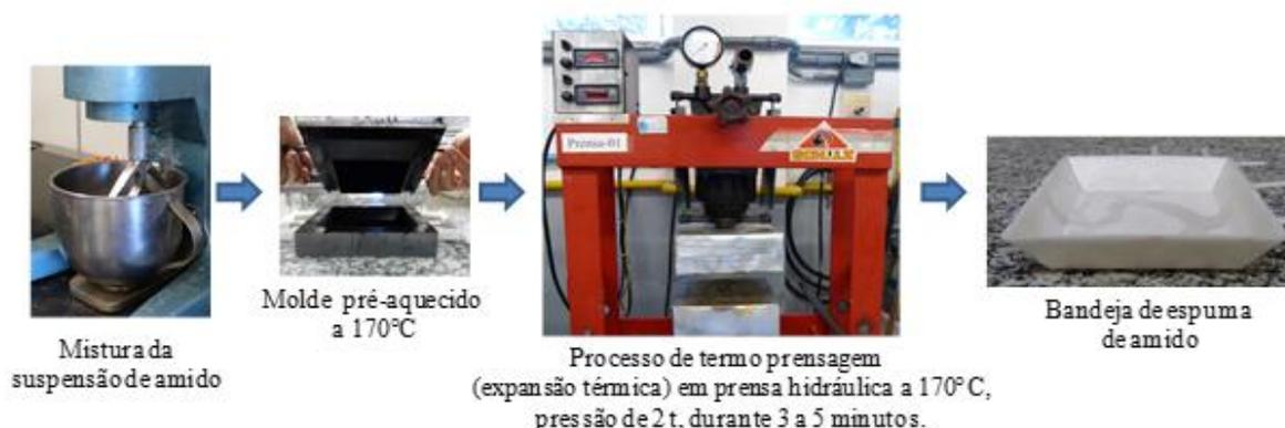
Figura 1. Processo de expansão térmica utilizado para obtenção das espumas de amido de mandioca.
