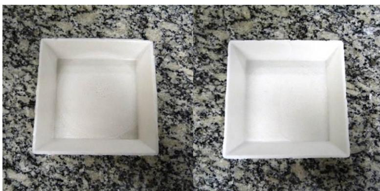
Figura 2. Bandejas de espuma de amido de mandioca obtidas por expansão térmica sem revestimento (à direita) e com revestimento de PLA (à esquerda).
