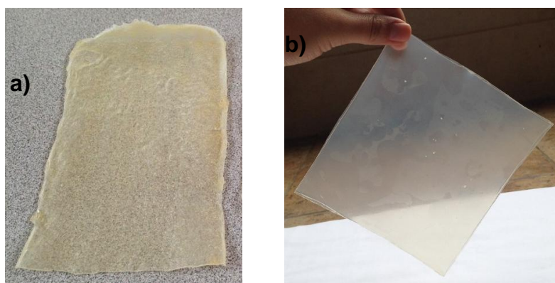
Figura 2. a) Material resultante del procesamiento en el molino de rodillos y b) Lámina obtenida posterior al proceso de prensado
