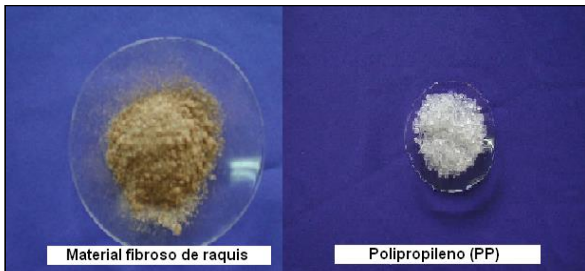
Figura 1. Fotografías de sustrato y matriz polimérica para la elaboración del MC.
